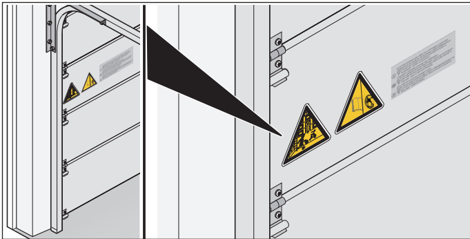
III. 1.2 Pose des autocollants sur le tablier
