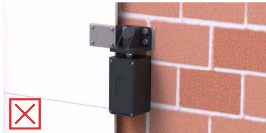
Het slot NIET opwaarts verticaal monteren.
