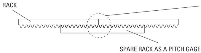
**IMPORTANT:** IN THE JOINT BETWEEN THE RACK RODS MAKE SURE YOU RESPECT THE PITCH BETWEEN THE TEETH, USING A SPARE RACK DURING THE ASSEMBLY PHASE IN ORDER TO OBTAIN THE CORRECT SHAPE
