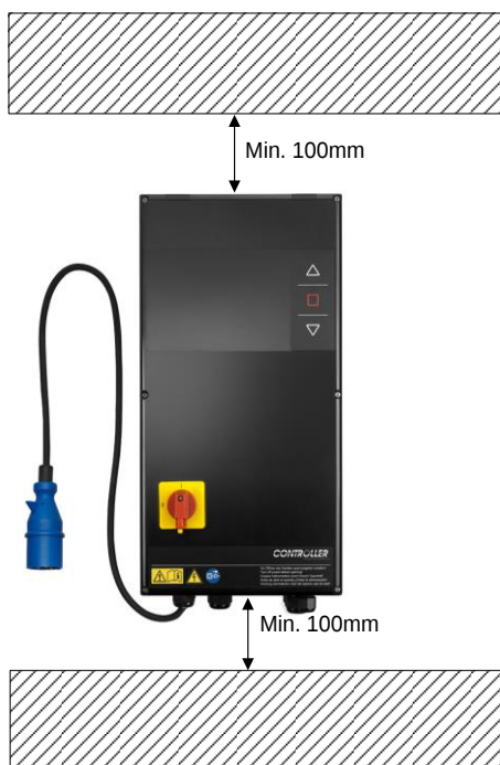
Afbeelding 1: Montage van de besturing
