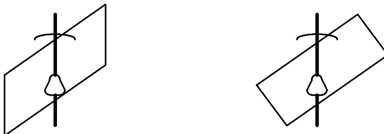
Bild 5: Verbesserung der Durchflutung mittels Trapezschleife oder schräger Rechteckschleife
