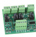
I/O Uitbreidingsprint: voor uitbreiding I/O op Door Controller met 4 inputs / 4 output- relais (NO en NC)
