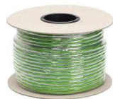
BUS SPlnet kabel op rol 100m. Bestaande uit 2 getwiste paren van 0,50 mm 2
