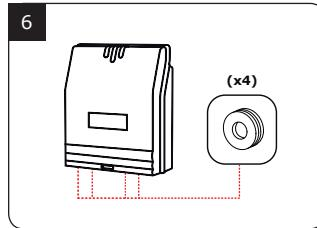
Bevestig het GALEO-toetsenbord op de achterplaat met behulp van de meegeleverde (M4x10) Torx®-schroef en T20 Trox-schroevendraaier. Plaats de Schroefdop aan de onderkant van het klavier.
