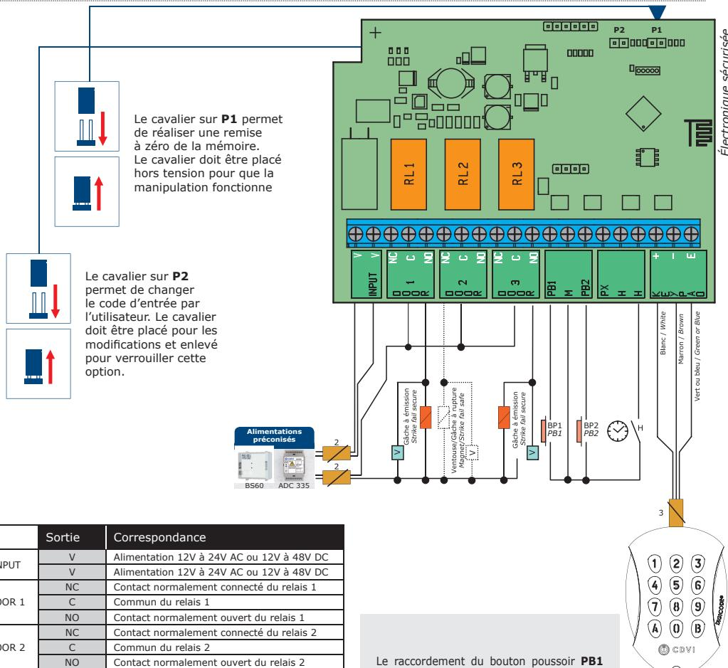
Le raccordement du bouton poussoir **PB1** est prévu pour commander le relais 1. Le raccordement du bouton poussoir **PB2** est prévu pour commander le relais 2. Le mode et la temporisation sont programmables.
