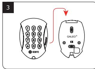
Controleer de afstand tussen de GALEO en de gescheiden elektronica (zie pagina 11 «Herinneringen en aanbevelingen»). Gebruik de gescheiden elektronica bevestigingsplaat en de GALEO om markeringen te maken en de 2 bevestigingsgaten te boren (boor Ø 5 mm en minimum diepte = 35 mm). Ten slotte de opening voor de doorgang van de elektrische kabel voor het toetsenbord.
