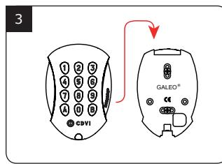
Vérifiez la distance entre le **GALEO** et son électronique sécurisée (Voir page 9 «Rappels et préconisations»). A l'aide de la plaque de fixation de l'électronique sécurisée et du **GALEO**, prenez les marques et percez les 2 trous de fixation (forêt Ø 5 mm et profondeur minimum = 35 mm) ainsi que l'ouverture pour le passage du câble électrique destiné au clavier.
