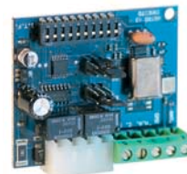
ASTRO 43/2 R Radio-ontvanger insteekkaart
