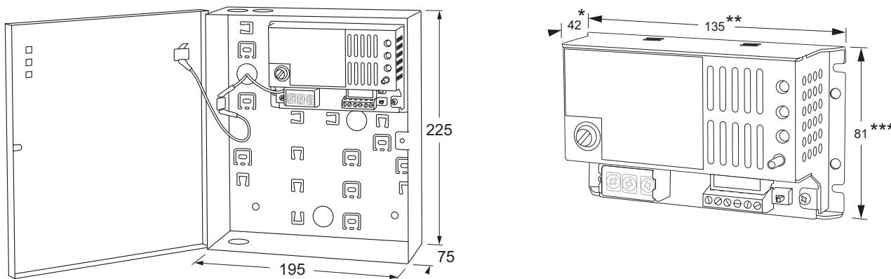
Met DIN rail adapters / With DIN rail adaptors / Avec adaptateurs rail DIN / Mit Hutschienen Adapter:
